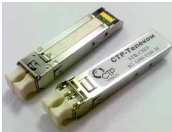
Рис.2. Оптический трансиверный модуль СТР-CSFP-G-1310/1490
