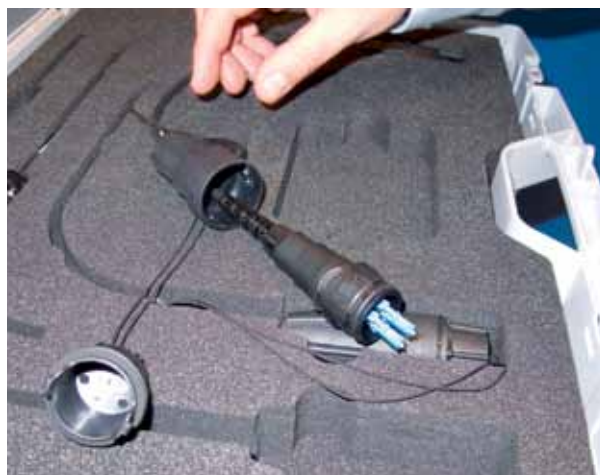
Коннектор FullAXS с оптическим разъемом LC
