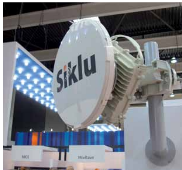
Радиорелейная система EtherHaul для E-диапазона с 31-см антенной
