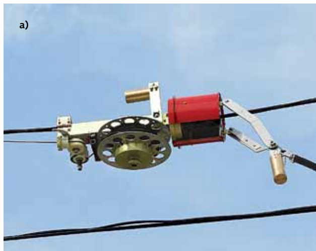
Рис.2. Оптические жгуты: а) навивка очередного ОК на жгут; б) дроп-муфта на 24 порта с выведенными на жгут навивными кабелями
