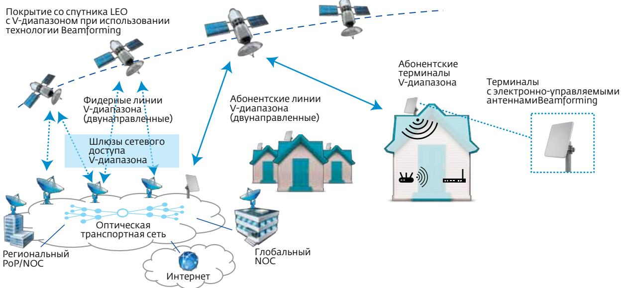
Рис.3. Спутниковый сегмент 5G компании Boeing
