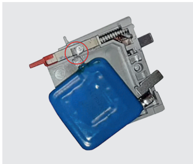
Рис.15. Сменный модуль. Контакт (обведен красным кругом) разомкнулся, механический индикатор выскочил из корпуса, показывая, что сменный модуль неисправен
