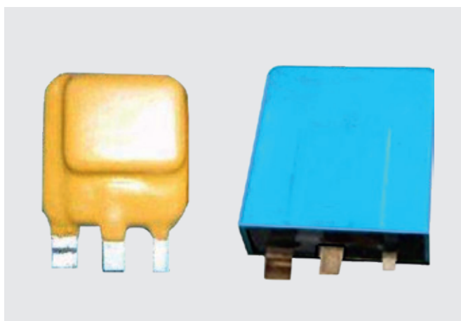
Рис.16. Варисторы, выполненные по технологии TVT
