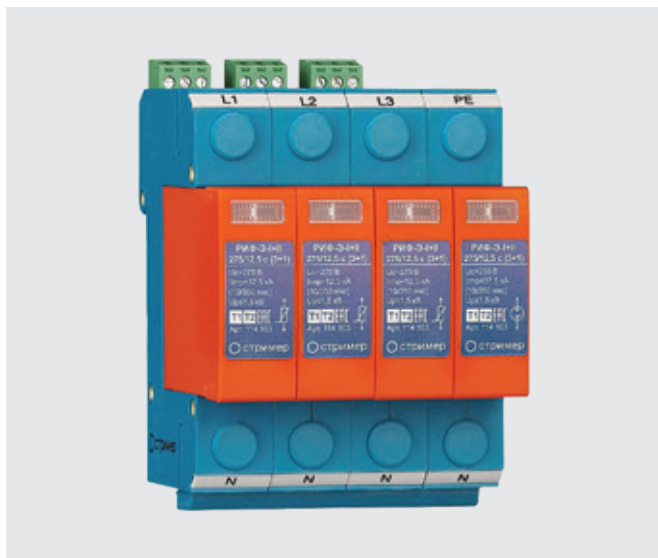
Рис.17. Трехфазный УЗИП. Для защиты каждой фазы в цепи L–N подключен сменный модуль, который имеет свои контакты контроля. Четвертый модуль, для подключения между N и PE, выполнен на разряднике и контролировать его не надо (см. примечание 10). Источник: www.streamer.ru
