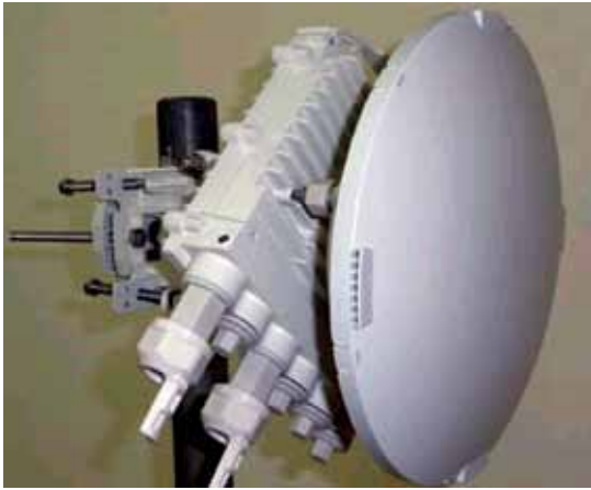
Рис.5. Радиорелейная станция E-диапазона компании E-band Communications
