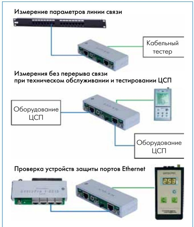
Рис.8 Примеры подключения измерительных приборов с помощью адаптера MA-GCS
