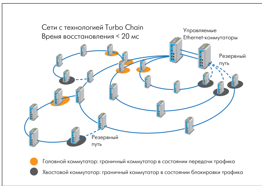
Рис.4. Пример резервирования с помощью технологии Turbo Chain
