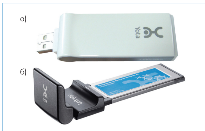
Рис.7 Абонентские устройства сети Yota: а) – SWC-U200, б) – SWC-E100 (Samsung)
