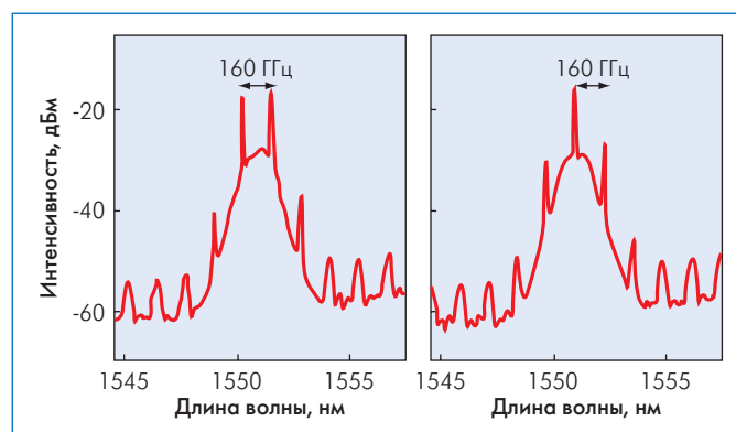
Рис. 1 Оптический спектр выходного 160 Гбит/с сигнала: а) формат CS-RZ; б) формат синфазного RZ
