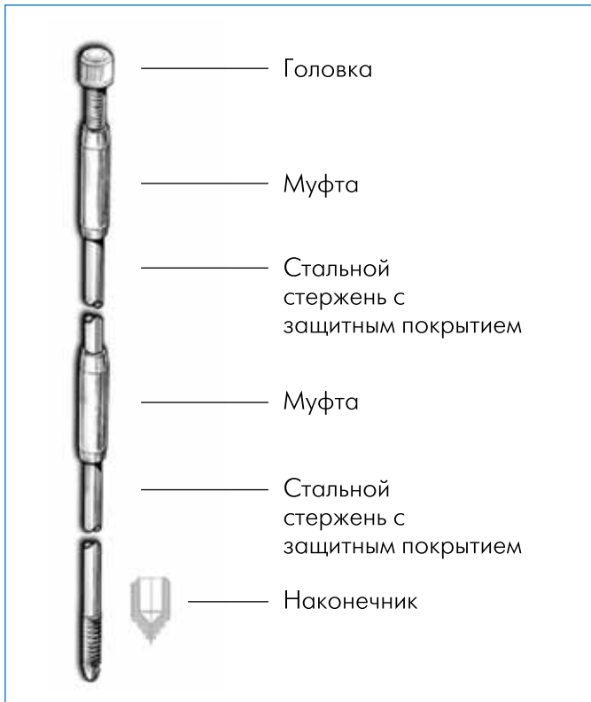
Рис. 12 Конструкция глубинного заземлителя
