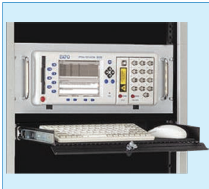
Рис.2 Рефлектометр для простейшей организации мониторинга
