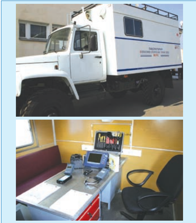
Рис. 8 Передвижная лаборатория по монтажу, ремонту и восстановлению ВОЛС
