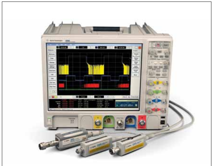
Анализатор пиковой мощности 8990B с широкополосными датчиками N1923A и N1924A
