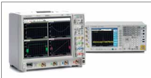
Рис.4. Применение анализатора сигналов PXA в режиме понижающего преобразователя к осциллографом Agilent Infiniium серии 9000
