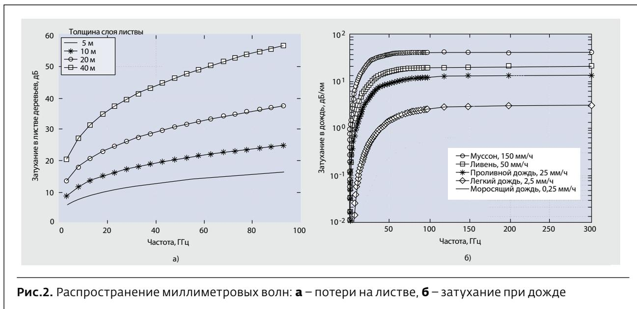
в листе\*. Например, что на частоте 80 ГГц и при глубине листового слоя 10 м потери могут достигать 23,5 дБ, что на 15 дБ выше, чем потери на частоте 3 ГГц (рис.2а).
