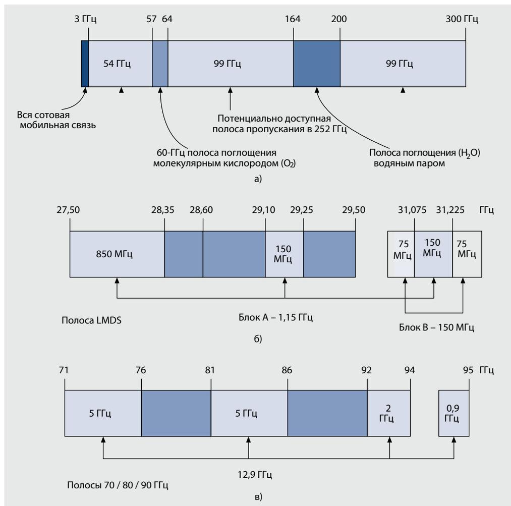
**Рис.1.** Спектр в миллиметровом диапазоне: **а** – полосы, доступные для широкополосной мобильной связи; **б** - лицензируемые диапазоны LMDS; **в** – E-диапазон
