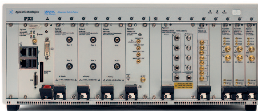
Рис.1. Векторный анализатор сигналов в PXIe-шасси M9018A, трехканальная конфигурация. Установлены 4-канальный понижающий преобразователь M9362A-D01, 12-разрядный АЦП M9202A, генератор M9302A, ВЧ-аттенюатор M9168C и усилитель/аттенюатор промежуточной частоты M9352A
