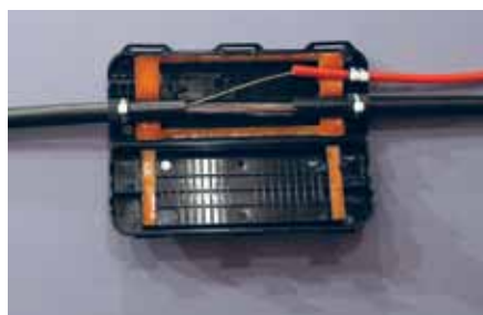
Рис.11. Кабель внешней прокладки с выделением модуля через боковое окно, герметизация гелевой муфтой
