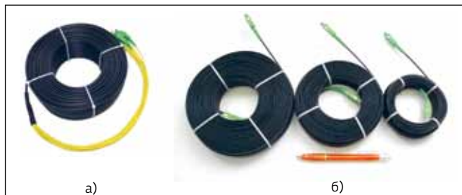
Рис.14. Навивные кабели: а – бухта 100 м 12-волоконного кабеля, имеющего с одной стороны разъемы SC; б – бухты 100, 60 и 20 м одноволоконного оптического кабеля, оконцованного с обеих сторон разъемами SC
