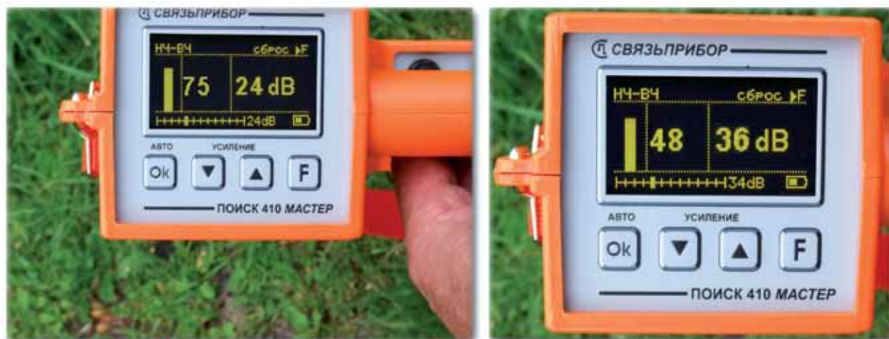
Рис.2. Показания прибора до и после повреждения на кабеле ТПП-5 длиной 1,2 км. Сопротивление повреждения жила-земля 1,2 кОм
