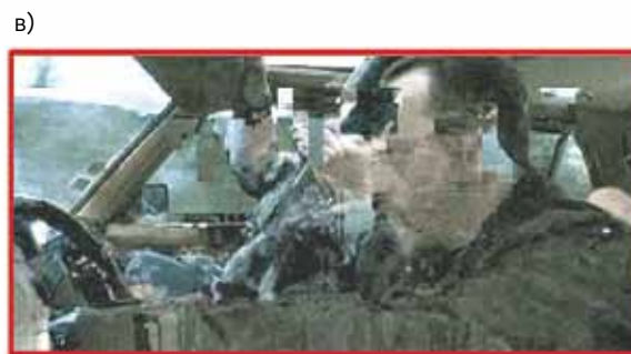
Рис.4. Влияние потери пакетов на изображение IPTV (а – потерь пакетов нет, б – 0,5% потерянных пакетов, в – 5% потерянных пакетов)
