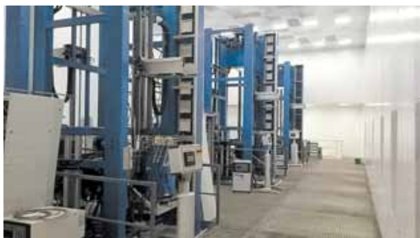
Верхние модули башен вытяжки оптического волокна (система загрузки преформ, 8 этаж)
