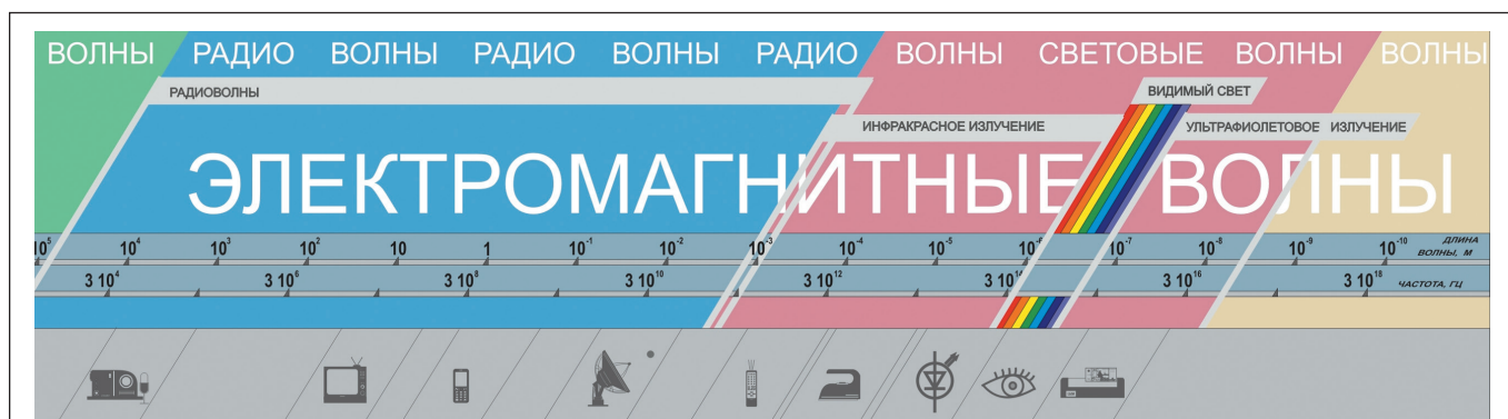
Рис.4. Шкала электромагнитных волн
