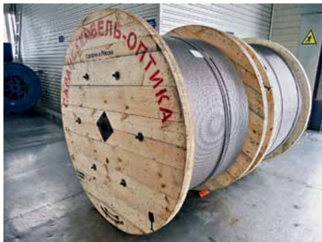
ОК, встроенный в грозотрос, – серьезный вклад СКО в импортозамещение
