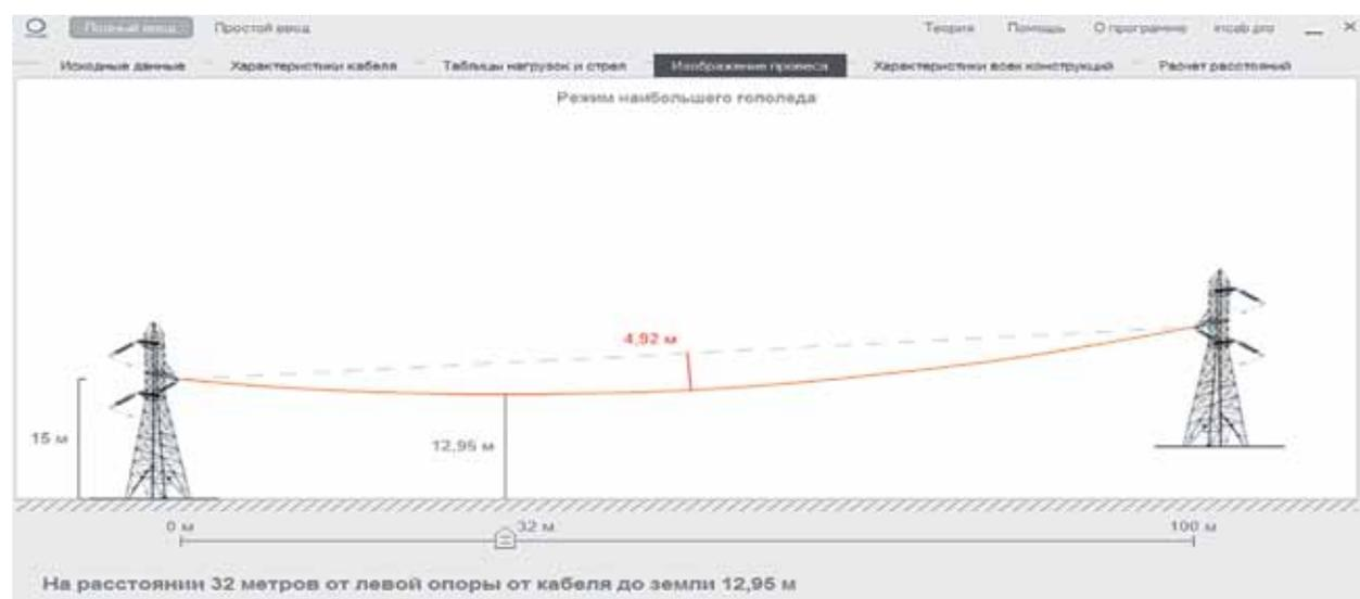
Рис.8. Визуальный результат в программе "Расчет самонесущих кабелей"
