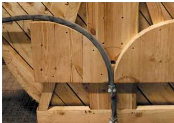
Рис.2. Установка для испытаний с изогнутым кабелем
