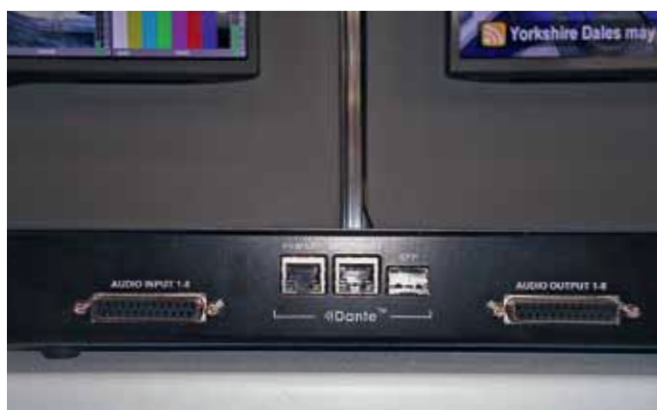
Преобразователь аудиосигнала REAI-9088 – первое устройство "ПРОФИТТ" с поддержкой протокола DANTE
