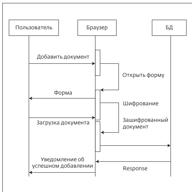
Рис.4. Диаграмма последовательности действий прецедента "Шифрование документа при добавлении"
