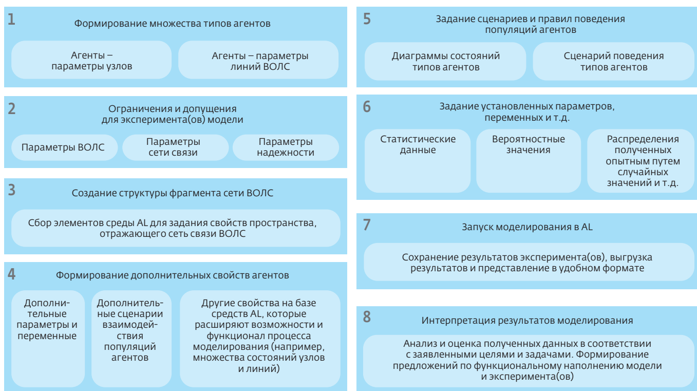
Рис.3. Структурно-логическая схема формирования модели резервирования в среде AnyLogic
