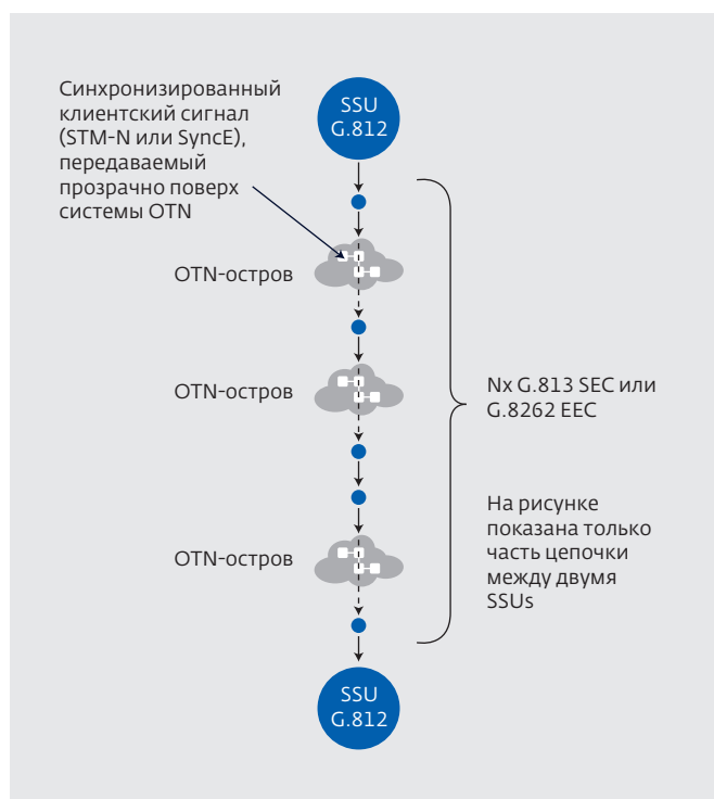
Рис.3. Графическая интерпретация цепочки узлов для передачи тактовой информации (ITU-T G.803 и G.8251) при сочетании технологий SDH/SyncE и OTN
