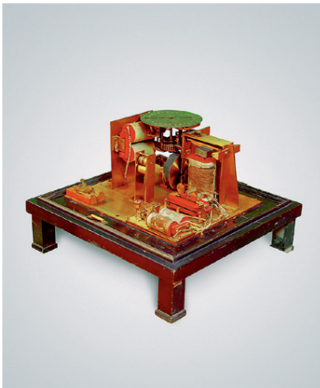
Рис.1. Буквопечатающий стрелочный телеграфный аппарат конструкции Б.С.Якоби со штепсельной передачей (опытный образец). Россия, 1850
